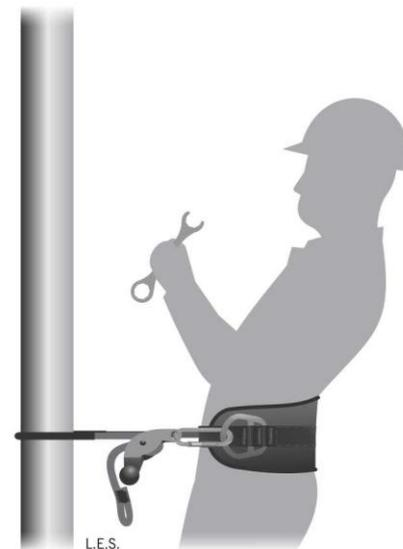
Ele deve ser ajustável e oferecer um ou mais elementos de engate aos quais é fixado o talabarte de posicionamento ou restrição.
