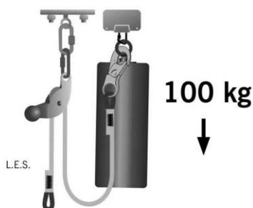
O cinturão e o talabarte são submetidos a um **ensaio dinâmico**. Os testes são separados, mas ambos são submetidos a uma queda de fator 1 suportando uma massa de 100 kg.
